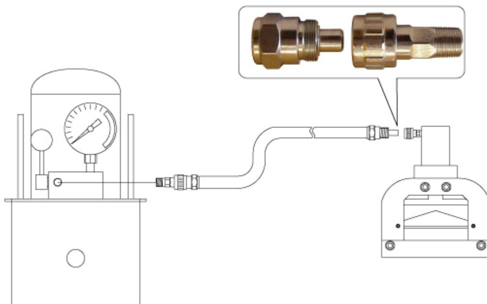
Используя распределительный гидравлический КГР-ЗП, позволяет подключать одновременно до трех инструментов к станции.
